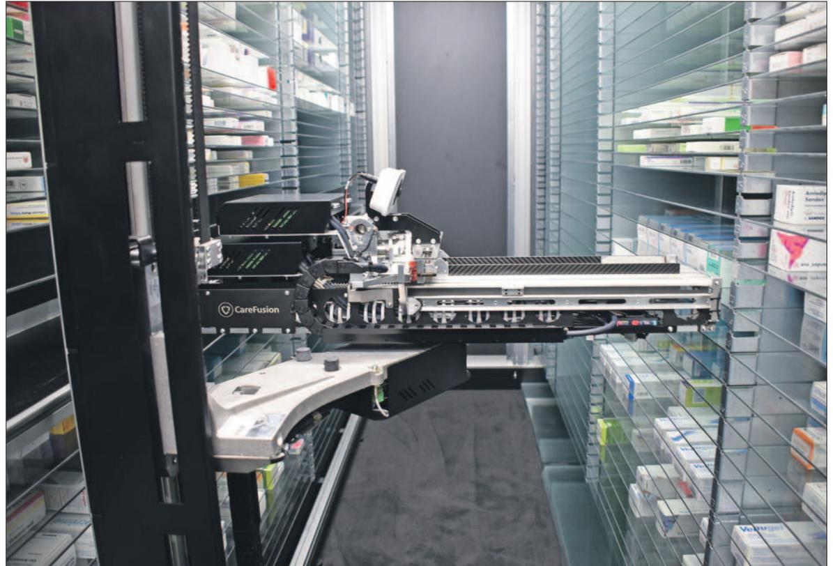
Das Herz der Anlage. Das Kommissionierungsgerät sorgt für die Ein- und Auslagerung der Medikamente.
